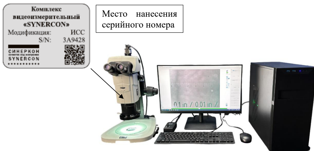
Рисунок 4 – Общий вид комплекса видеоизмерительного SYNERCON модификации ИСС и место нанесения серийного номера
