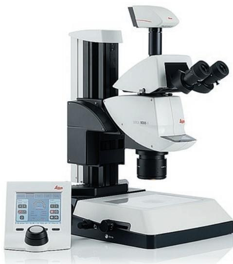
Универсальные стереомикроскопы с ручным управлением (модели M205 C и M205 A могут быть моторизованны), планохроматическими объективами, с прочной и жесткой конструкцией, парфокальным револьвером и имеют модульную структуру, которая позволяет создать необходимый для Ваших исследований инструмент. Микроскопы также могут быть оснащены десятками различных окуляров, тубусов, штативов и новейшими светодиодными осветителями LED3000 и LED5000.
