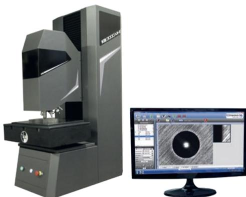
Универсальные твердомеры с диапазонами нагрузок от 0,5 до 3000 кгс по шкалам Виккерса, МикроВиккерса, Бринелля, Роквелла, Супер-Роквелла, методу вдавливания шарика для пластиков, а также при измерениях твердости по невосстановленному отпечатку инденторами по Виккерсу и Бринеллю.
