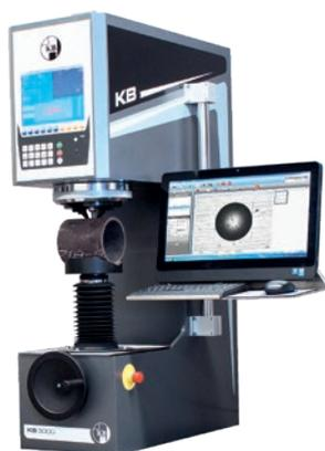
Универсальные твердомеры с диапазонами нагрузок от 0,5 до 3000 кгс по шкалам Виккерса, МикроВиккерса, Бринелля, Роквелла, Супер-Роквелла, методу вдавливания шарика для пластиков, а также при измерениях твердости по невосстановленному отпечатку инденторами по Виккерсу и Бринеллю.
