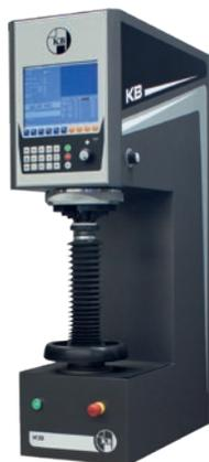
Диапазон нагрузок 1-250 кгс, позволяет проводить испытания по шкалам Роквелла, Супер-Роквелла и измерения твердости по невосстановленному отпечатку при применении инденторов Бринелля и Виккерса. Модели КВЕ с движущейся измерительной головкой позволяют измерять твердость образцов высотой до 320, 390, 600 или 900 мм.
