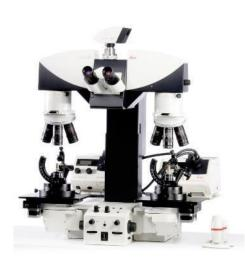
**Область применения:** Микроскоп предназначен для проведения всех видов исследований при баллистической и трасологической экспертизе.
